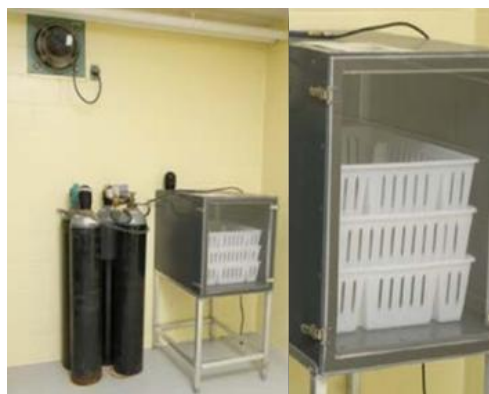
圖4 市售CO2密閉箱，應按照製造商的指示進行使用，可透過透明視窗觀察動物狀況。(圖片來源：Poultry Industry Council)
