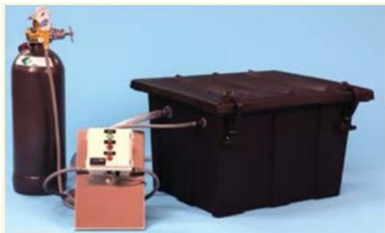
圖3 密封箱可自己訂製，確保密封性。可放置調節器以控制氣體流動，及檢測低濃度的傳感器或警報器，以及排氣閥以防止過壓。(圖片來源：Poultry Industry Council)
